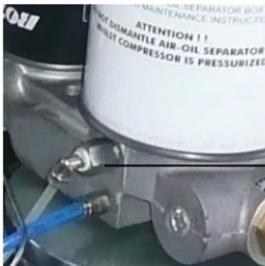
Figura 12.4-4 Recuperarea uleiului de la duză
